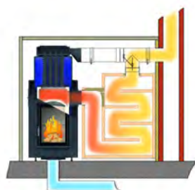
Fonctionnement accumulateur avec clapet Moritz (trappe basculante)
