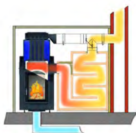
Fonctionnement accumulateur avec clapet Moritz (trappe basculante)
