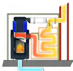
Fonctionnement accumulateur avec clapet Moritz (trappe basculante)
