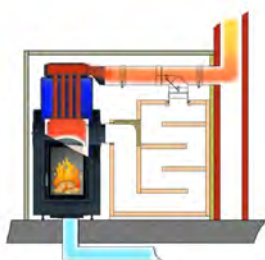
Fonctionnement chaudière avec clapet Moritz
