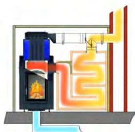
Fonctionnement accumulateur avec clapet Moritz (trappe basculante)
