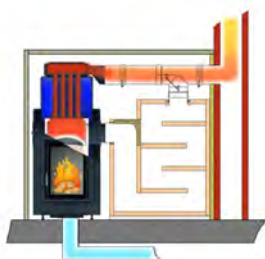
Fonctionnement chaudière avec clapet Moritz
