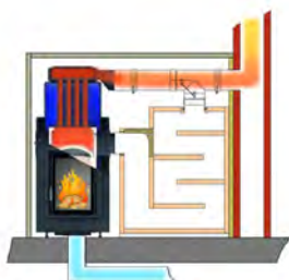
Fonctionnement chaudière avec clapet Moritz
