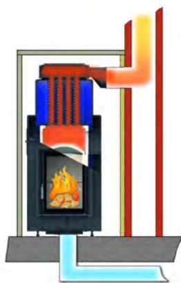
Fonctionnement chaudière avec connection directe
