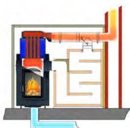
Fonctionnement chaudière avec clapet Moritz
