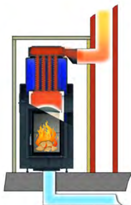
Fonctionnement chaudière avec connection directe
