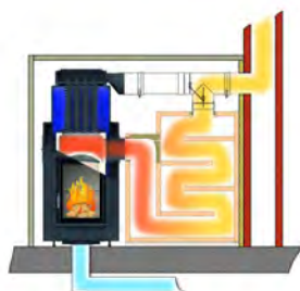
Fonctionnement accumulateur avec clapet Moritz (trappe basculante)
