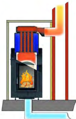
Fonctionnement chaudière avec connection directe
