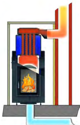
Fonctionnement chaudière avec connection directe
