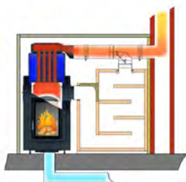
Fonctionnement chaudière avec clapet Moritz
