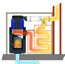
Fonctionnement accumulateur avec clapet Moritz (trappe basculante)
