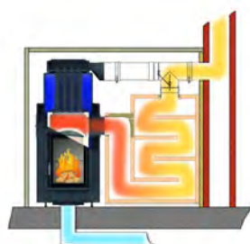
Fonctionnement accumulateur avec clapet Moritz (trappe basculante)
