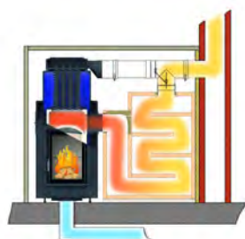
Fonctionnement accumulateur avec clapet Moritz (trappe basculante)
