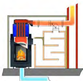
Fonctionnement chaudière avec clapet Moritz
