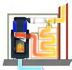
Fonctionnement accumulateur avec clapet Moritz (trappe basculante)
